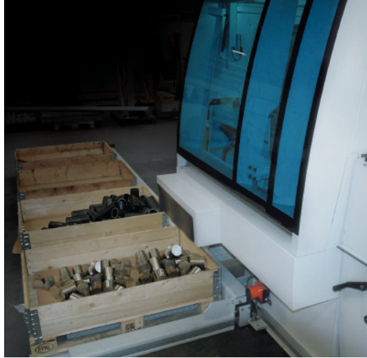
Abschnitt-Sortiereinrichtung mit mehreren Palettenplätzen.
