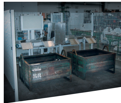
Sortier- und Zählereinrichtung für Sägeabschnitte
