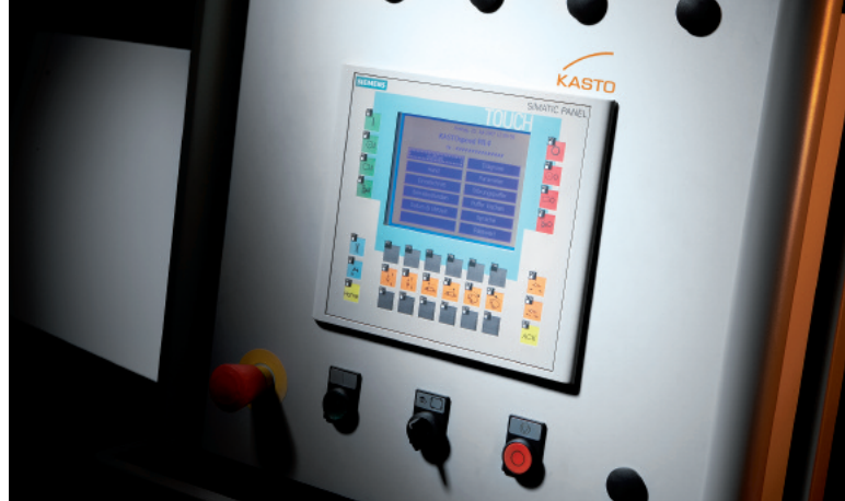
Maschinensteuerung Siemens mit Technologieeingabe über Touch-Screen.
