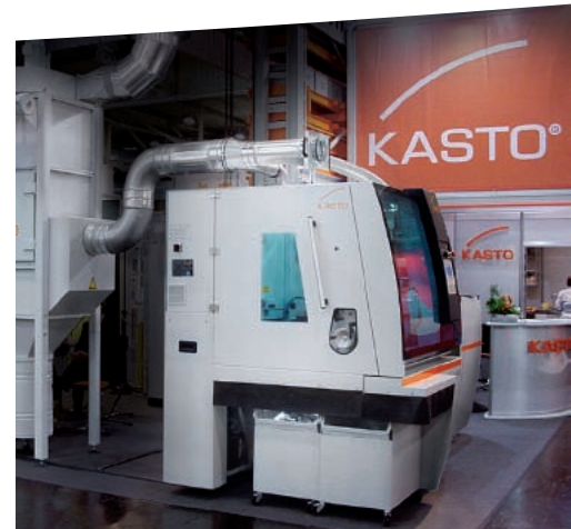
KASTOspeed M 9 mit Absauganlage für Aluminiumspäne in Messeausführung.
