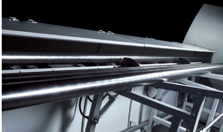
Schrämagazin mit Ladescheiben und Zufuhrrollenbahn.
