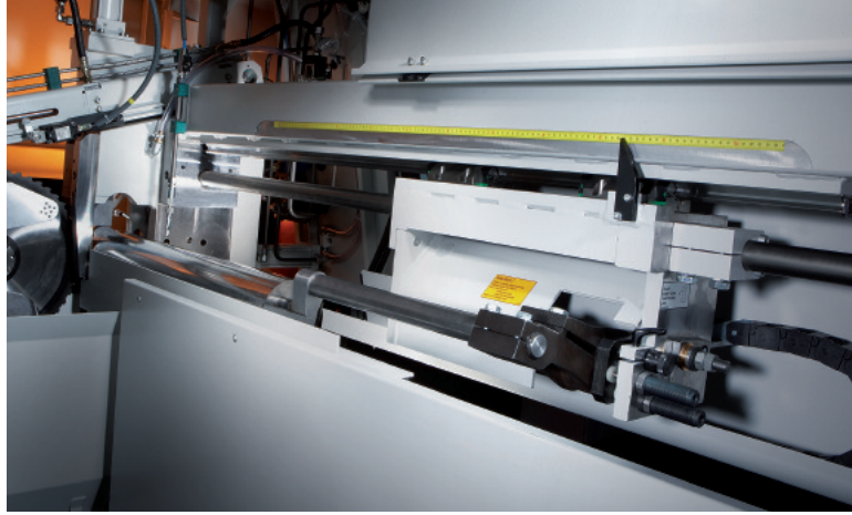
Manuell einstellbarer Messanschlag, z.B. mit 1.000 mm Abschnittlänge.
