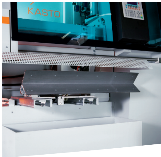
Kipptisch mit prismatischer Übergabe-einrichtung und Schrottbehälter.
