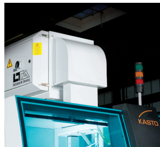
Elektrostatischer Luftfilter und Meldeleuchte.
