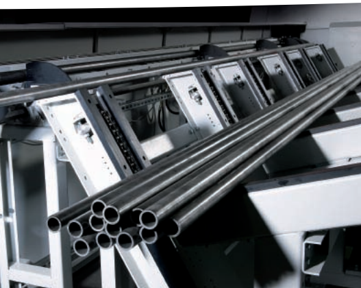
Bundlader mit Material in Ladeposition.
