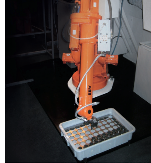
Entnahme und Sortierung von Kleinteilen mit einem Roboter.
