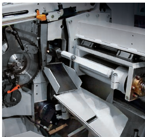
Sortierweiche für Reststücke, Gutteile und Anschnitte.
