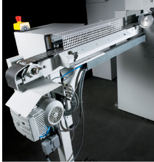
Abschnitt-Abfuhrband mit Schiebeeinrichtung (Ausführung „nach links“).
