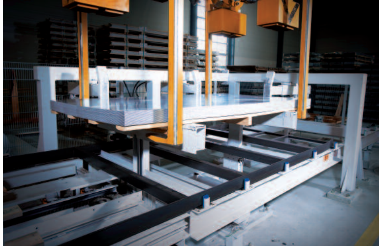
Beladung einer doppelttiefen Blechpalette mit Hilfe einer Überhubeinrichtung.
