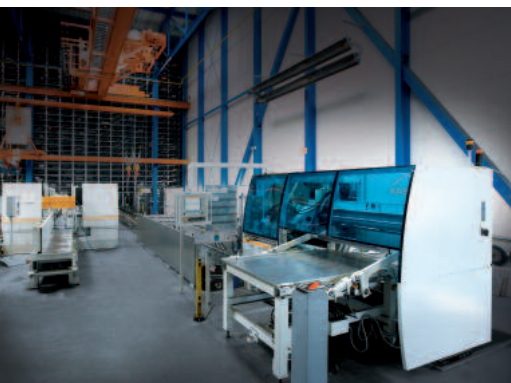
KASTO Sägemaschinen an einer Pufferstation.
