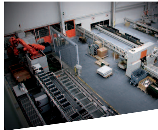
Wabenlager mit integrierten Sägemaschinen.
