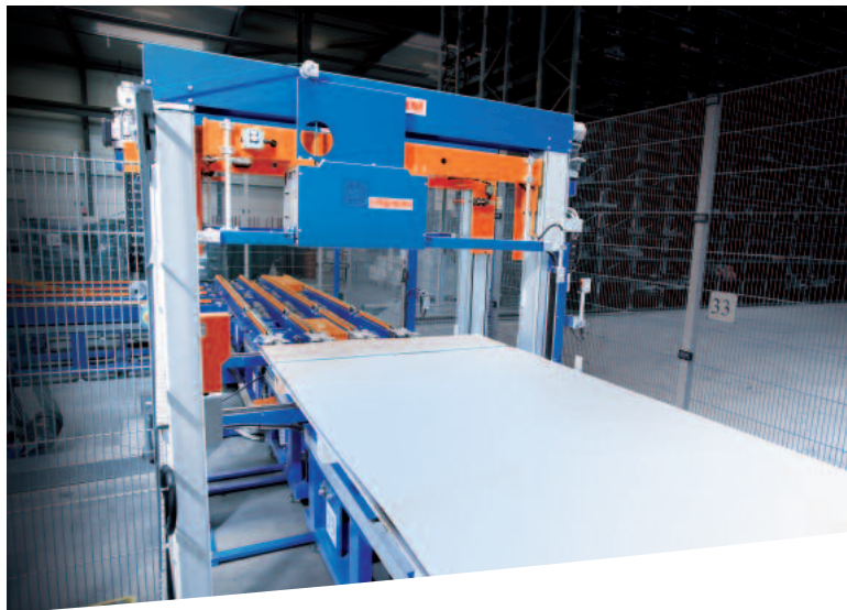
Vollautomatisch integrierte Umreifungseinrichtung mit Förderanlage.
