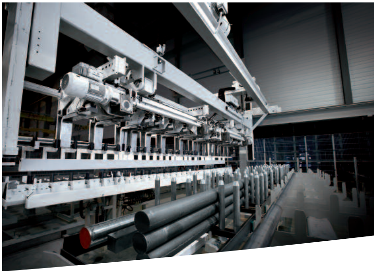
KASTO Einzelstabmanipulator bei der Vereinzelung aus einer Kassette von oben.
