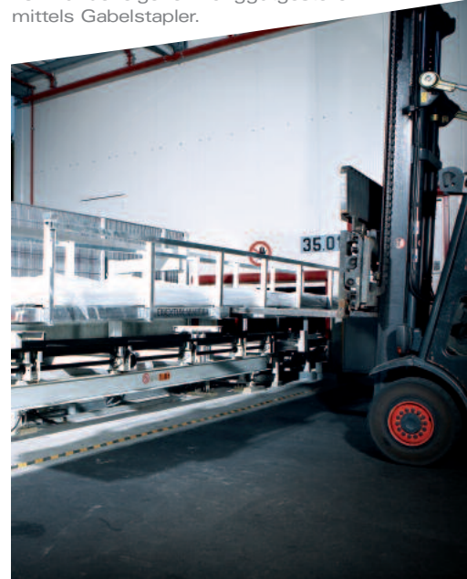
Einlagerstation mit Hubeinrichtung und Anschlagportal zur einfachen Einlagerung von kundeneigenen Langgutgestellen mittels Gabelstapler.
