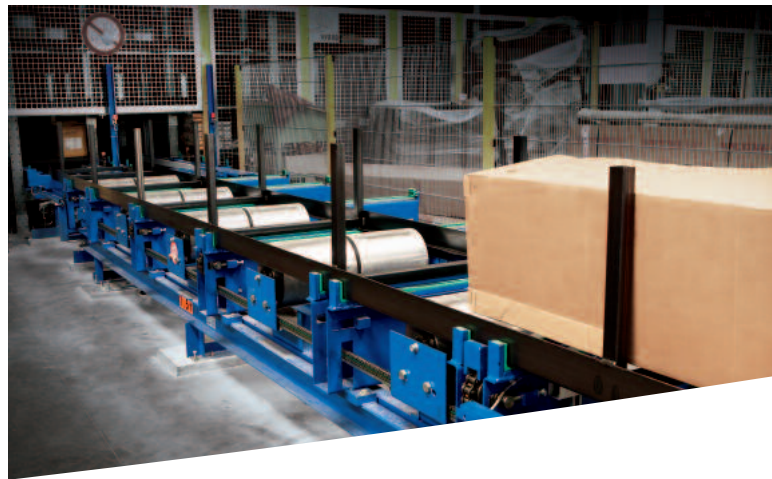
Station mit integrierter Rollenbahn.
