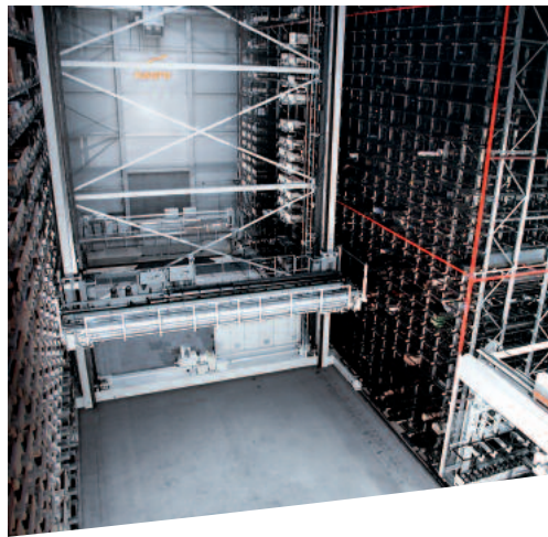
Wabenlager mit Sägezelle als Logistikzentrum für Langgut, Blech, Europaletten mit Sägezelle.
