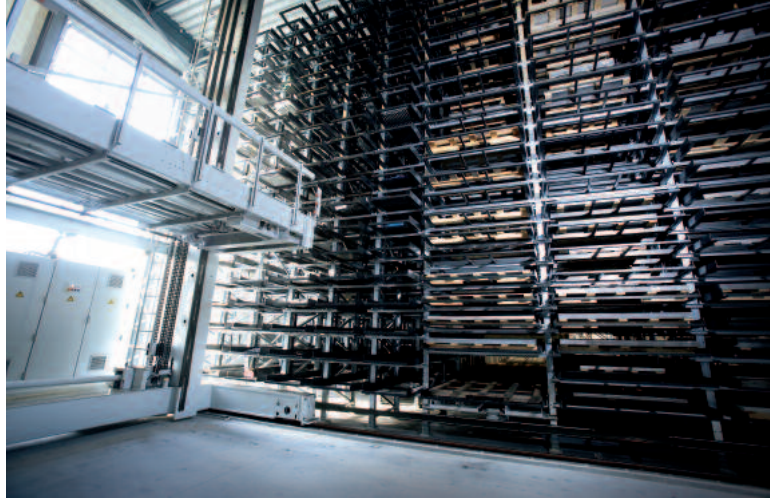
Blick in die Regalgasse eines „DUO-Systems“ für Langgut/Blech.
