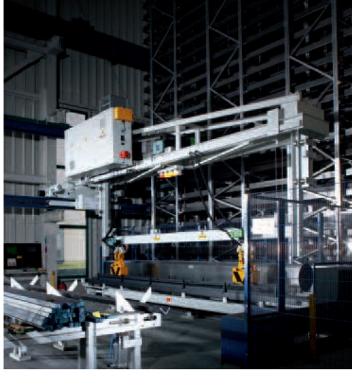
KASTO Kommissioniergerät mit Magnetanlage.
