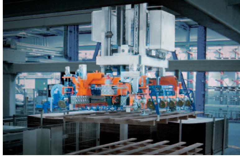
Blech-Manipulator in vollautomatischer Ausführung.
