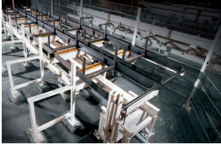
KASTO Standard-Wabenlagerkassette auf einer Station.
