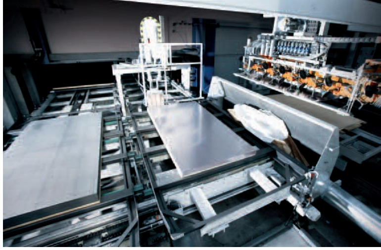
Umlaufstation mit vollautomatischer Blechkommissionierung.
