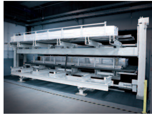
Umlaufstation an der Lagerstirnseite mit Schutzhaube für Kassettenwechsel während der Materialentnahme.
