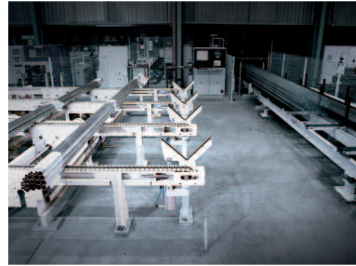
Vertikalumlaufstation lagerstirnseitig mit zehn logischen Plätzen.
