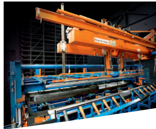
Kommissioniergerät mit Vakuumtraverse für nicht-magnetisches Langgutmaterial.
