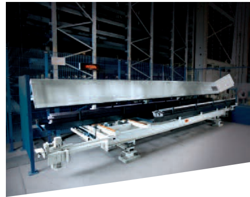
Einlagerstation mit Hubeinrichtung und Anschlagportal zur einfachen Einlagerung von kundeneigenen Langgutgestellen mittels Gabelstapler.
