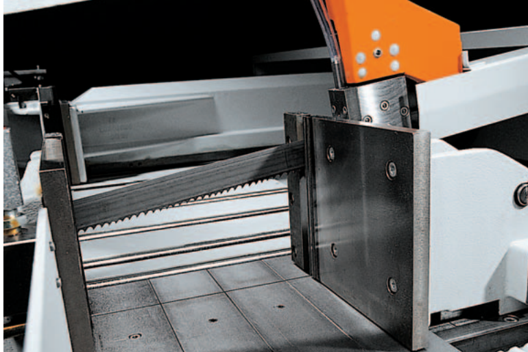
Querschnittsbezogene Materialauflageplatten schützen die Gleitführungen.
