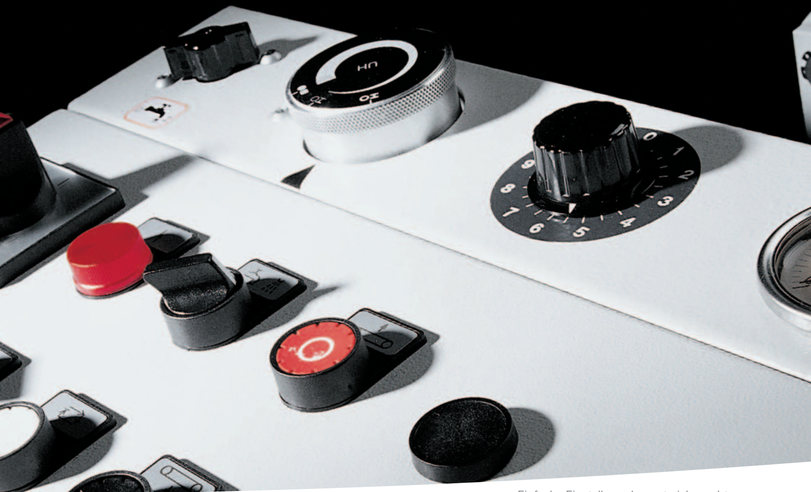
Einfache Einstellung der materialgerechten Balance zwischen Schnittkraft und Vorschubgeschwindigkeit: die KASTO Universalhydraulik.
