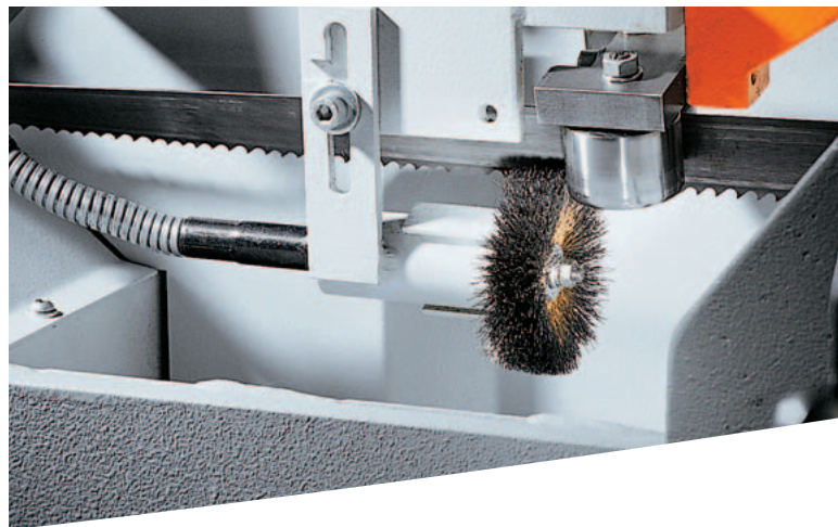
Standardausstattung der KASTOpos GA: angetriebene Späneraubbürste.
