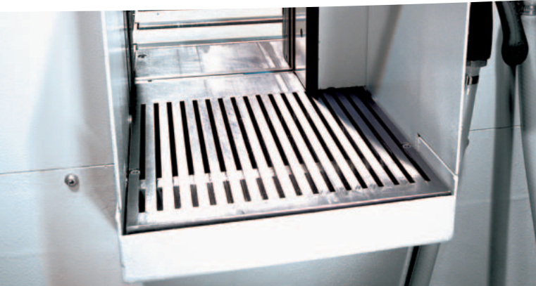
Späne- und kühlmitteldurchlässiger Materialablagetisch.
